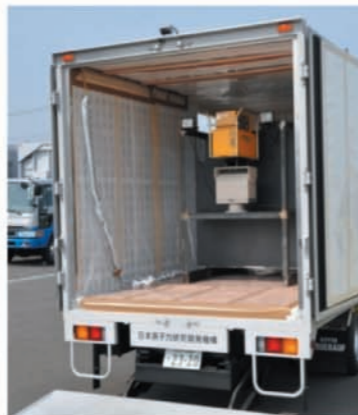
オペレーションBOXに設置されたガンマカメラ(黄色部分)
