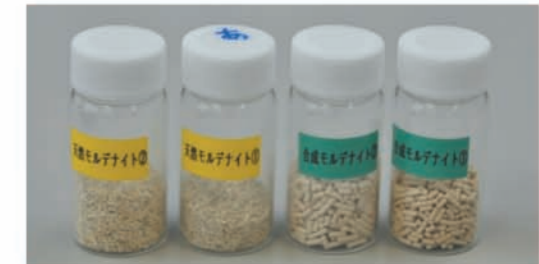
天然ゼオライト (黄色ラベル) と合成ゼオライト (緑色ラベル)。天然ゼオライトでは、仙台市愛子 (あやし) 産のモルデナイトがよく知られている。
